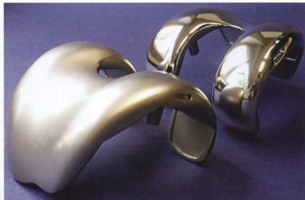
Bild 2: Kniekondyle aus CrCoMo links unbehandelt, rechts plasmapoliert
